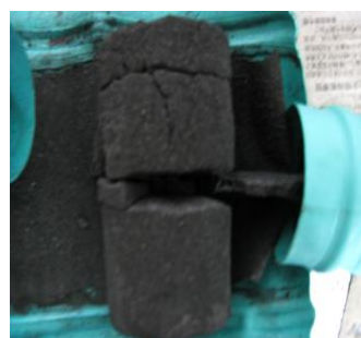
图4 煤样破坏情况
